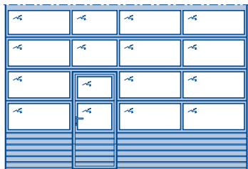
Секционные ворота APU F42 с калиткой без высокого порога
