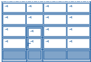
Секционные ворота ALR F42 с калиткой без высокого порога
