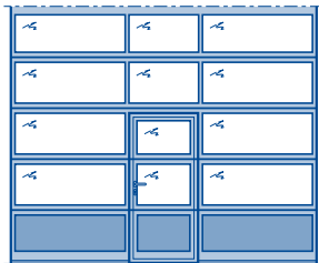
Секционные ворота ALR F42 с калиткой без высокого порога
