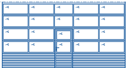
Секционные ворота APU F42 с калиткой без высокого порога
